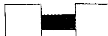
ADEKA ULTRA SEAL, volgt door zwelling de ontstane ruimte en biedt blijvende afdichting.....
